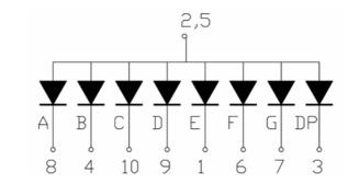
产品线路图 INTERNAL CIRCUIT DIAGRAM:
